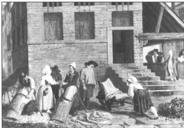
Le travail de rivière dans une tannerie. Au premier plan, deux ouvriers tanneurs écharnent des cuirs sur leur chevalet de rivière. Au second plan, à droite, on distingue sous un hangar, deux autres ouvriers affairés autour d'une cuve utilisée pour le "dessaignage" des peaux fraîches ou le "reverdisage" des peaux sèches. Tableau de DeFrance (XVIII<sup>e</sup> siècle), Musée Marmottan, Paris.
